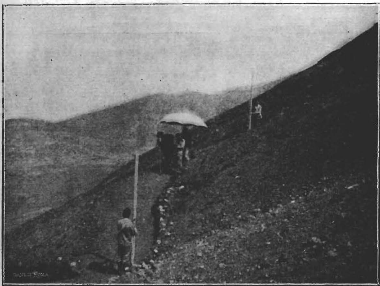
FIG. 4ª — Livellazione geometrica di precisione lungo la strada delle guide sopra il Gran Cono. (Fot. A. M.).
