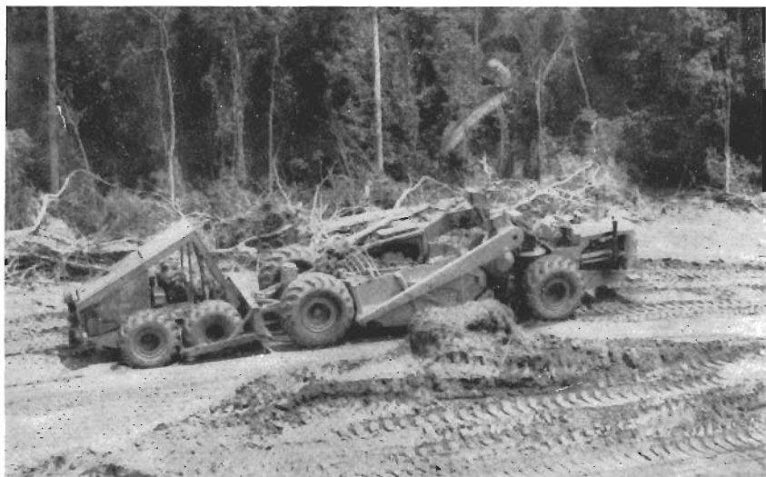
UN TREE ROLLER TRAINATO DA UN BULLDOZER .
