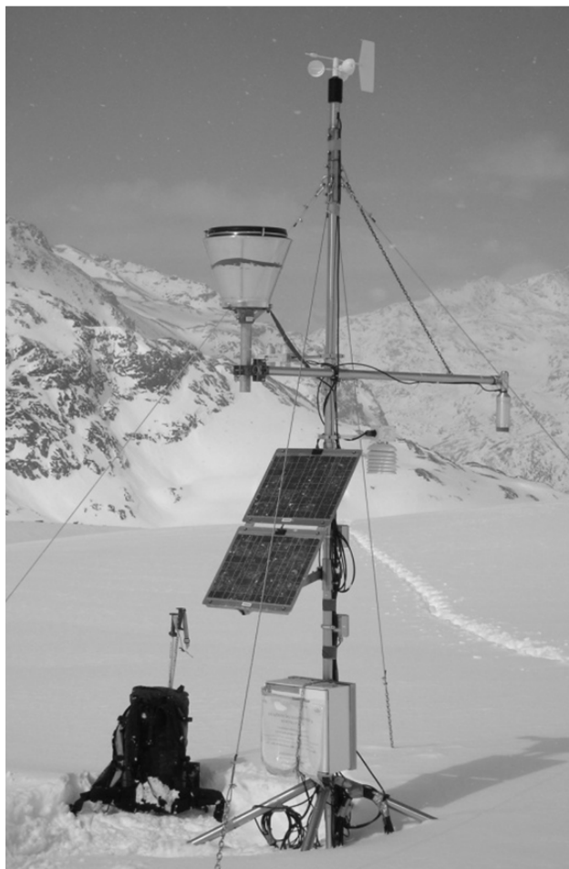
Fig. 2 – La stazione meteorologica permanente italiana (AWS) installata sul Ghiacciaio dei Forni (AWS1 Forni)
